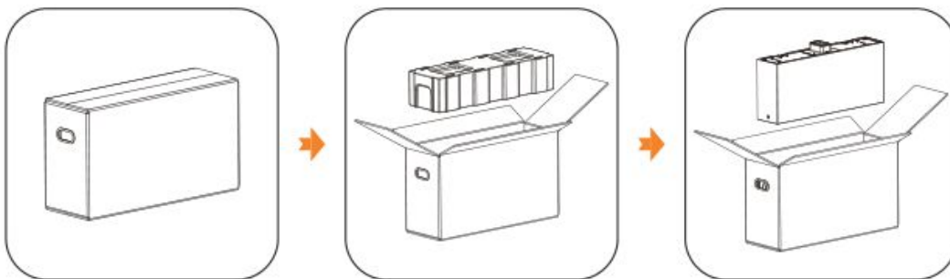
Obrázek 5-3 Vybalení bateriového modulu
