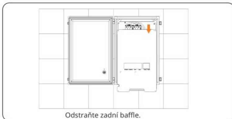
Obrázek 7-3 Odstraňování zadního baffle
