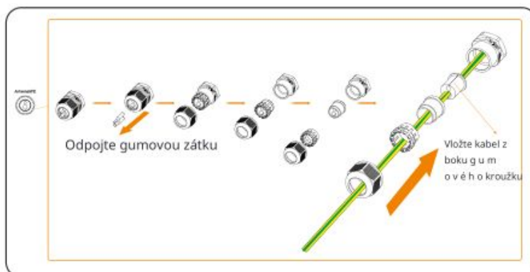
Obrázek 7-19 Protážení PE kabelu skrz Anténu&PE port
