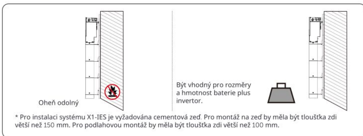
Obrázek 4-5 Požadavek na instalační nosič
