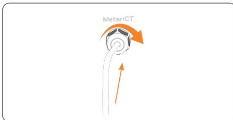
Obrázek 7-23 Vkládání kabelu CT
